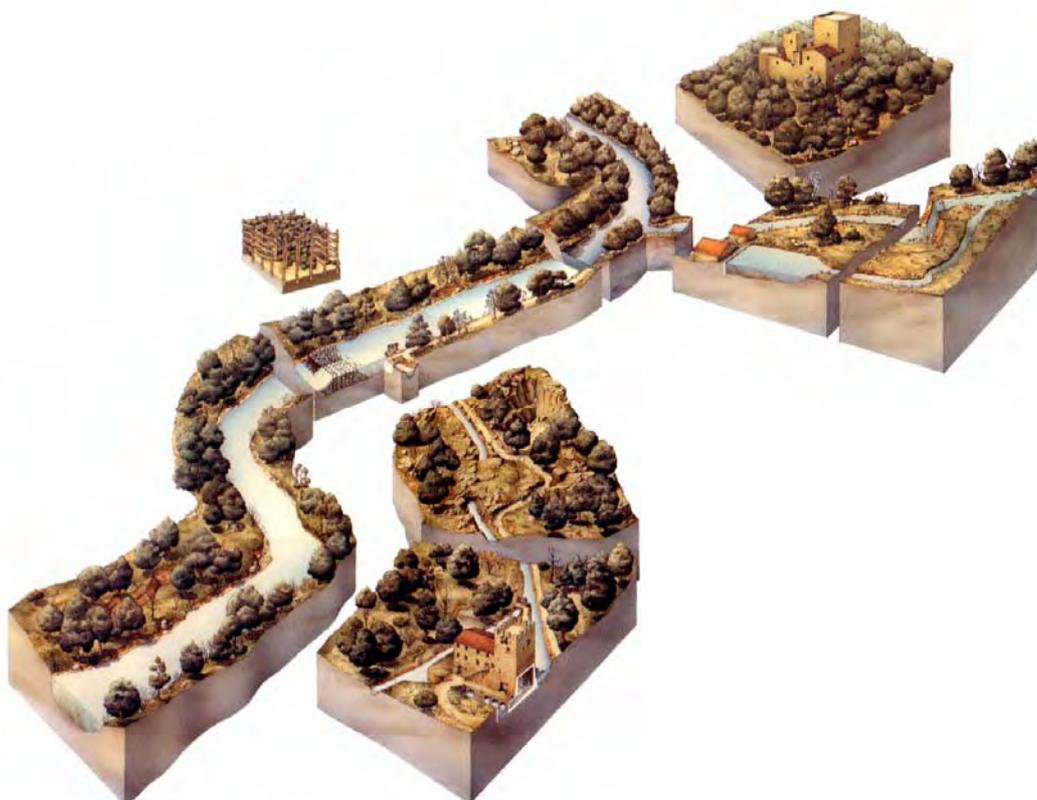
*Sezione schematica del territorio in corrispondenza del fiume merse, con evidenziato il sistema di prese per l'alimentazione dei mulini. Dall'alto Castiglione Balzetti e il piccolo mulino sul torrente Ricausa con il gorello e la gora. In basso e in dettaglio lo sbarramento della steccaia, la presa del gorello, il molino del Pero.*
